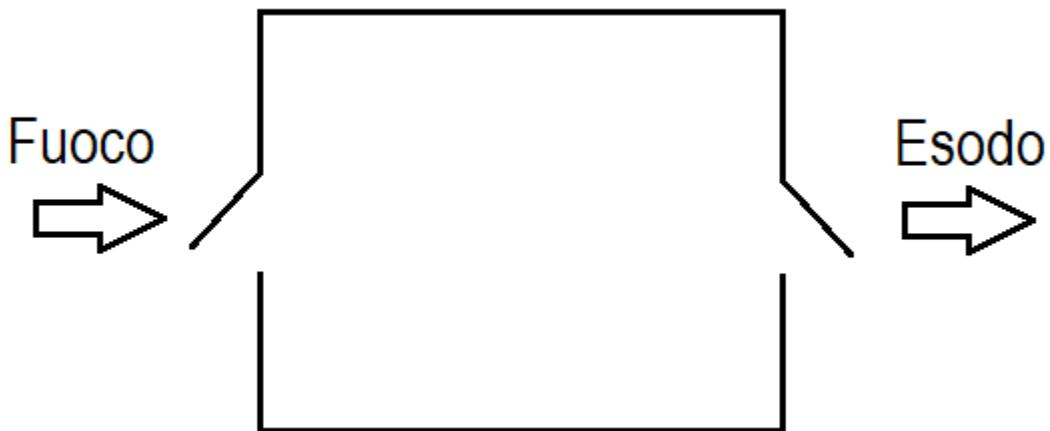
In questa modalità l'apertura della porta FUOCO o ESODO non risulta essere impedita dalla macchina. Alla chiusura, la macchina interrompe la ventilazione per 3 secondi, permettendone così la chiusura.
