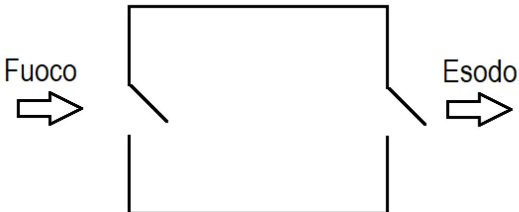
In questa modalità, all'apertura della porta FUOCO, la macchina interrompe la ventilazione per 3 secondi, permettendone così l'apertura. Alla sua riattivazione, la pressione generata facilita la chiusura della porta. L'apertura della porta ESODO non risulta essere impedita dalla macchina. Alla sua chiusura, la macchina interrompe la ventilazione per 3 secondi, permettendone così la chiusura.
