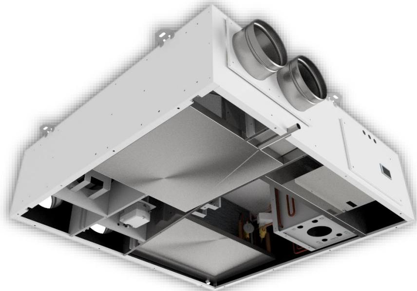
Unità di ventilazione a doppio flusso per il rinnovo dell'aria con recuperatore di calore e circuito frigorifero ad espansione diretta, il quale, collegato all'impianto di riscaldamento/raffrescamento dell'edificio, permette la deumidificazione (estiva) ed integrazione (estiva ed invernale) ottimizzando il comfort in ambienti dotati di sistemi radianti per il riscaldamento e raffrescamento.
